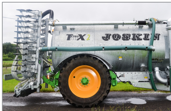
Wozy asenizacyjne TETRAX2 mają bardzo zwartą budowę, a osprzęt tylny jest mocowany blisko zbiornika
